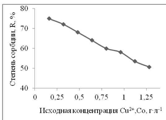
Рис.1. Зависимость степени сорбции от исходной концентрации иона меди (II).
